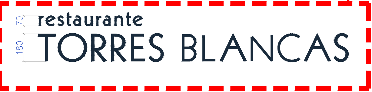
ROTULO EN LETRAS CORPOREAS DE ACERO 8 mm LACADAS RAL 5011 CON ESPESOR 3 cm FIJADAS A PARAMENTO EXISTENTE ALTURA 20 CM (TORRE)
